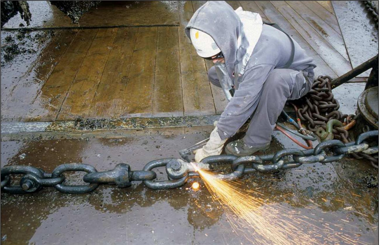
Le chalumeau découpeur sectionne en quelques instants des manilles et des maillons de 40 mm d'épaisseur.
