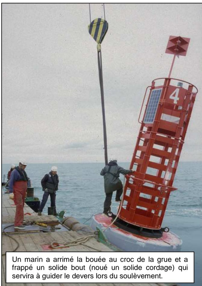
Un marin a arrimé la bouée au croc de la grue et a frappé un solide bout (noué un solide cordage) qui servira à guider le devers lors du soulèvement.
